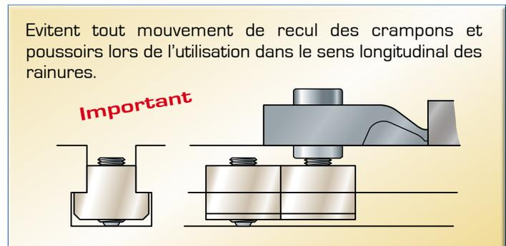
Permettent un alignement rapide et précis des crampons et des supports.
